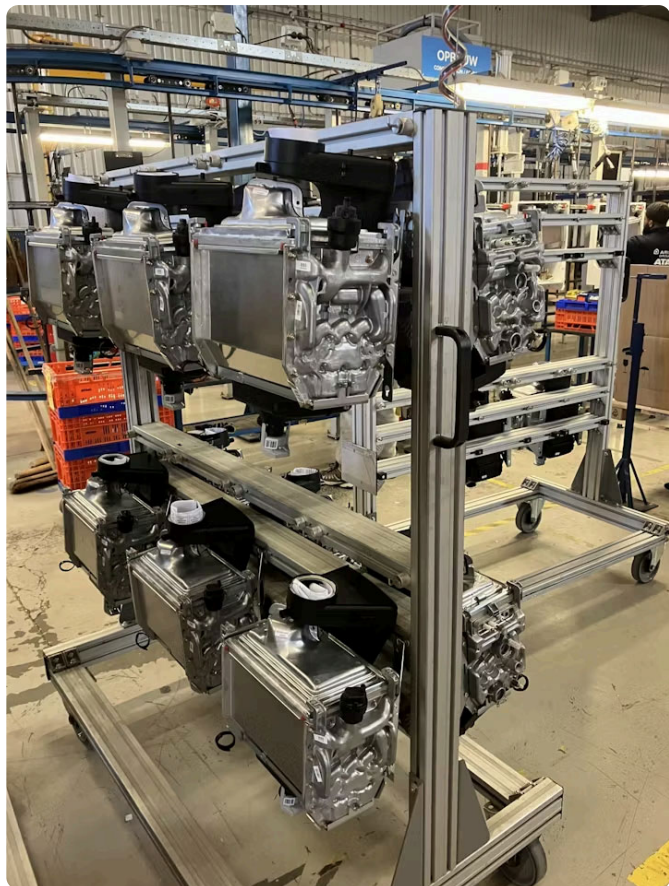
RVS-warmtewisselaars staan in de fabriek klaar om te worden geassembleerd.
