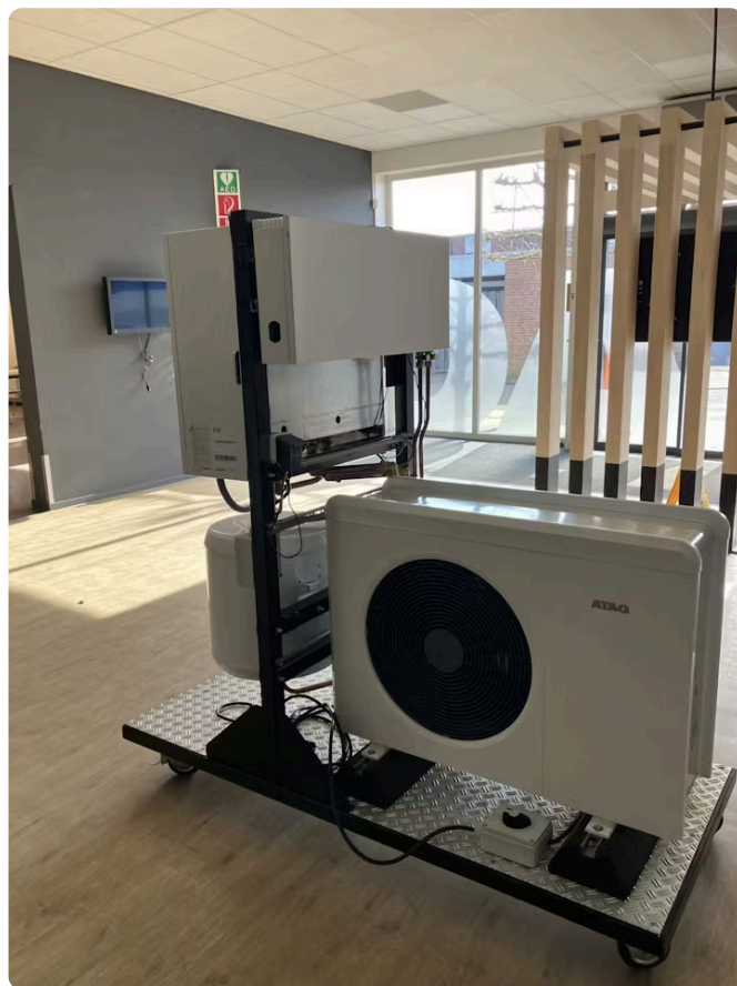
Een proefopstelling van de Energion met de karakteristieke buitenunit.
