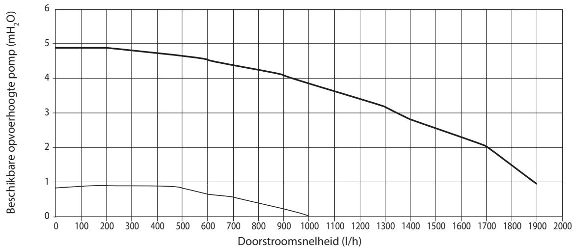
Beschikbare opvoerhoogte pomp zones 2 & 3 mengkraan hendel omlaag (A → AB)
