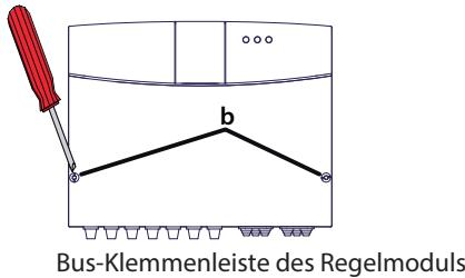
3) Die elektrischen Anschlüsse zwischen der „BUS“-Klemmenleiste am Kessel (B und T) und einer der zwei „BUS“-Klemmenleisten am Regelmodul (B und T) ausführen.
