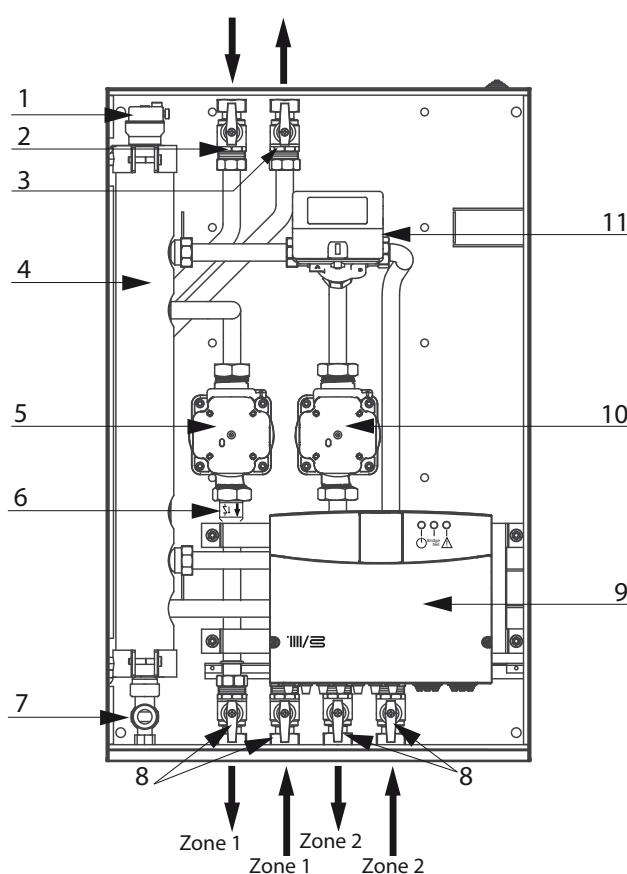
**Vue générale Module III du circuit de chauffage mixte**
