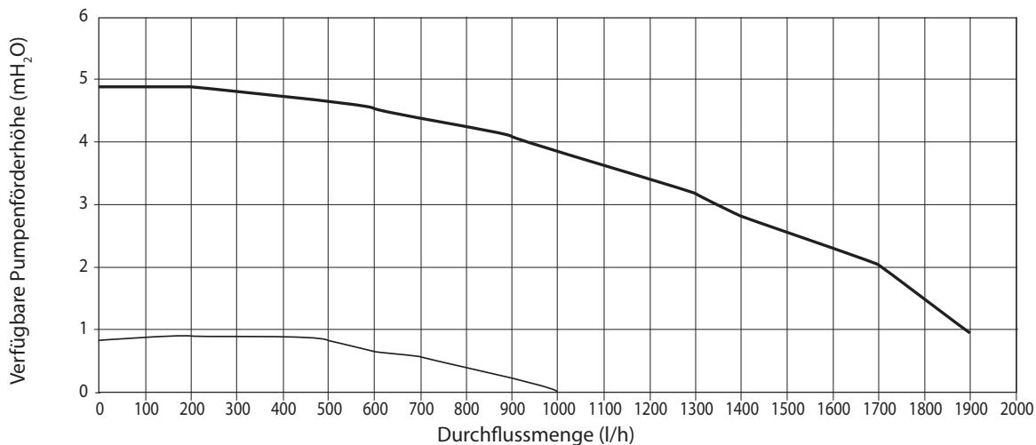
Zone 2 u. 3 Verfügbare Pumpenförderhöhe Mischventil, Hebel in unterer Stellung (A → AB)
